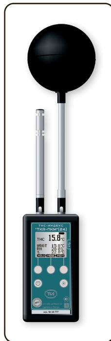
В комплект поставки входит чёрный шар (сфера) диаметром 90 мм; 2 батареи типа AA; штатив-трипод настольный (по заказу напольный штатив-трипод высотой h=1,3 м); кабель-удлиннитель для измерительного зонда; кабель связи с ПК (через USB) и диск с программным обеспечением.
