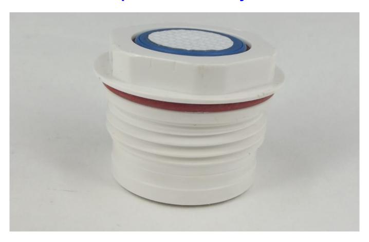
Сменный измерительный модуль является измерительным элементом, который используется в приборе «ГастроТест». Основным элементом модуля является электрохимический сенсор аммиака (электрохимический датчик). Срок службы сменного модуля составляет 12 месяцев со дня продажи прибора, но не более 600 тестов. По завершению срока службы подлежит замене. Масса модуля составляет 17 г, габаритные размеры – Ø 34 мм и высота 26 мм.
