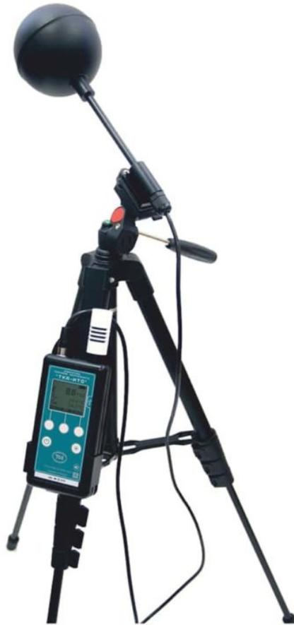
Принцип действия измерителя состоит в преобразовании падающего на черный шар теплового потока в электрический сигнал, пропорциональный плотности этого потока (облученности), с последующим масштабированием и индикацией результата измерения.
